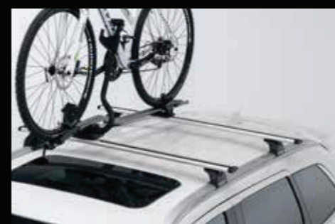
▲ Cykelholder Med integreret lås. Letvægtstype i aluminium, justerbar i taghøjde. MZ315032
