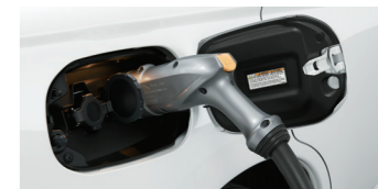
Hurtig opladning/Quick Charge Du kan anvende de hurtige ladestationer, når du er ude på længere køreture. Stikket er af CHAdeMO typen.
