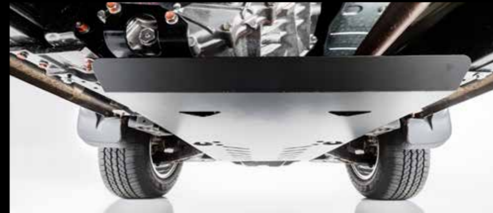
► Underkørselsplade cc/dc 2 mm stålplade, behandlet for at modstå korrosion. Delnumre fremgår af referencelisten.
