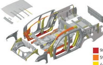
Karosseriet er ekstremt stabilt og let grundet fleksible højstyrkestålplader, der også bidrager til et højt sikkerhedsniveau ved kollision.
