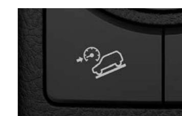
OBS: På biler med manuelt gear sættes driving mode-vælgeren i "4LLC"-tilstand. Når Hill Descent Control anvendes under kørsel – undtagen i "4LLC"-tilstand – kan motoren sætte ud, hvilket kan medføre tab af bremsevejen eller at hjulene låses.
