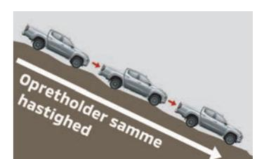
OBS: Hill Descent Control [HDC] kan ikke erstatte sikker kørsel. Stol ikke udelukkende på denne funktion, for ved kørsel på glatte veje, der er mudrede, belagt med is eller på uasfalteret vej, vil bilen ikke lade dig fastholde en bestemt lav fart. Se instruktionsbogen for mere information.
