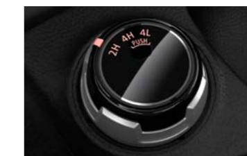
OBS: Easy Select 4WD lader dig skifte mellem 2H og 4H tilstand ved fart på op til 100 km/t. Bilens skal være standset, når der skiftes mellem 4H og 4L. Se instruktionsbogen for yderligere information
