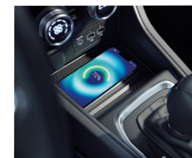
▲ Trådløs oplader Induktionsopladning af din smartphone.
