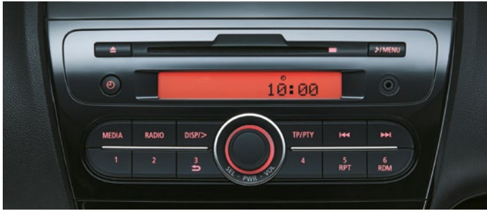
CD afspiller med AUX udgang og unikt centerpanel
