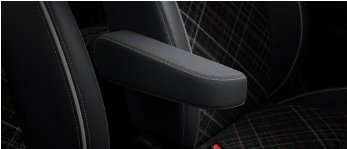
Justerbart armlæn ved førersædet Førersædet i CVT modeller er forsynet med et justerbart armlæn, som øger komforten og aflaster armen på lange køreture. Det kan justeres vandret for at opnå den ideelle position.
