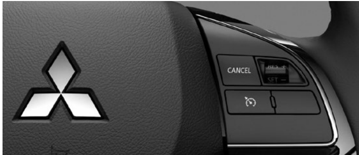
Fartpilot Bilens hastighed fastholdes automatisk, uden du behøver have foden på speederpedalen, hvilket giver en mere afslappet kørsel på lange ture. Når du træder på bremspedalen, frakobles systemet.
